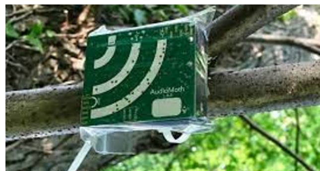
AudioMoth jeftin akustični senzor otvorenog koda (© Open Acoustic Devices)
